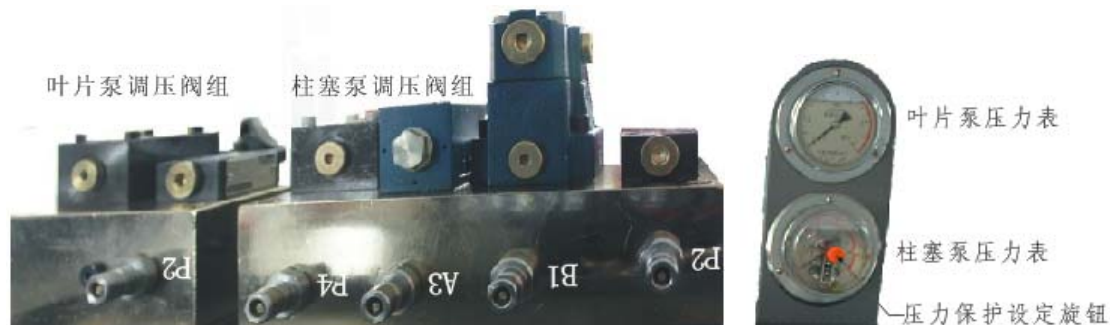
图4 工业双泵液压站油口钢印分布图
